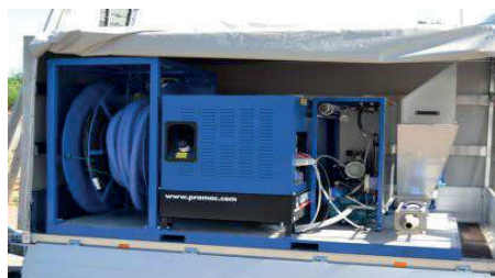
Un générateur de mousse transforme l'agent moussant liquide en mousse.
